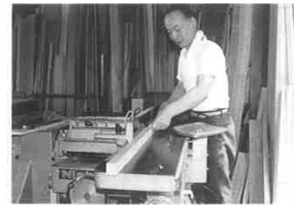
削り 万能機を使って直角を出し、厚さをそろえる。
