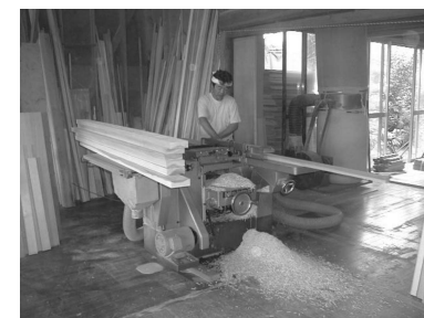
万能機で直角を出しているところ
